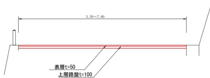
舗装構成図 (舗装工) S=1:10
